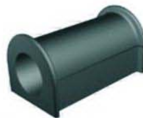
Artículo Nº. 5045 Buje barra estabilizadora delantera. Modelo: TRK112 Peso neto: 250g. Dimensiones: 70x120x63 Plano Nº 213604
