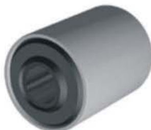
Artículo Nº. 5057 Buje elástico cabina. Modelo: R112-113 Peso neto: 450g. Dimensiones: ø 65x90 Plano N 320775/ 1356668/ 303805
